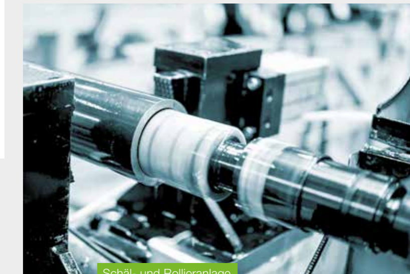
Schäl- und Rollieranlage
